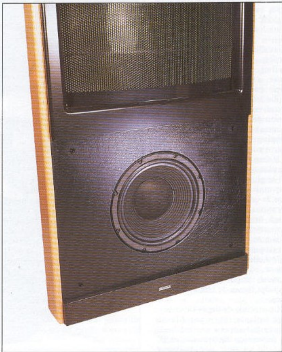
Le haut-parleur de grave monté en suspension acoustique est raccordé à 125 Hz avec la cellule statique fonctionnant en large bande au-delà.
