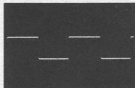
b) Signal carré à 1 kHz 200 V crête-à-crête entre les deux sorties.
