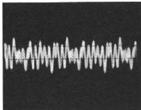
Fig. 10 : Cas d'un lecteur CD de bas de gamme (prix : 1\ 800 F environ) qui présente des fuites H.F. importantes ( 4,4 MHz environ) qui rendent impossibles les mesures des figures 8 et 9.
