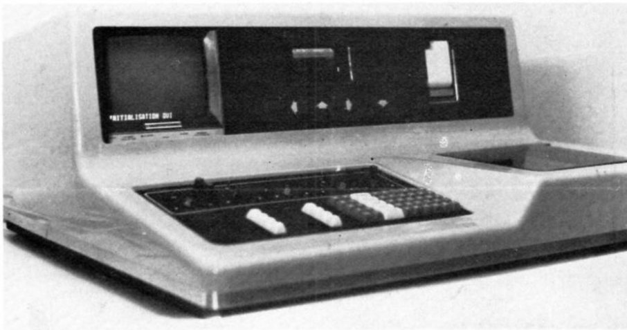
ANATEC : dispositif de lecture rapide de bande magnétique (système Holter). Document MICROMED.
