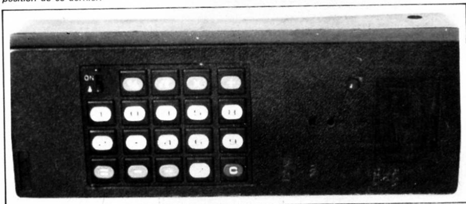
Ce boîtier de télécommande expérimental, muni d'un HP miniature, travaille dans la bande 300-3400 Hz (essais concluants sur réseaux téléphoniques, radiotéléphoniques et de sonorisation).
