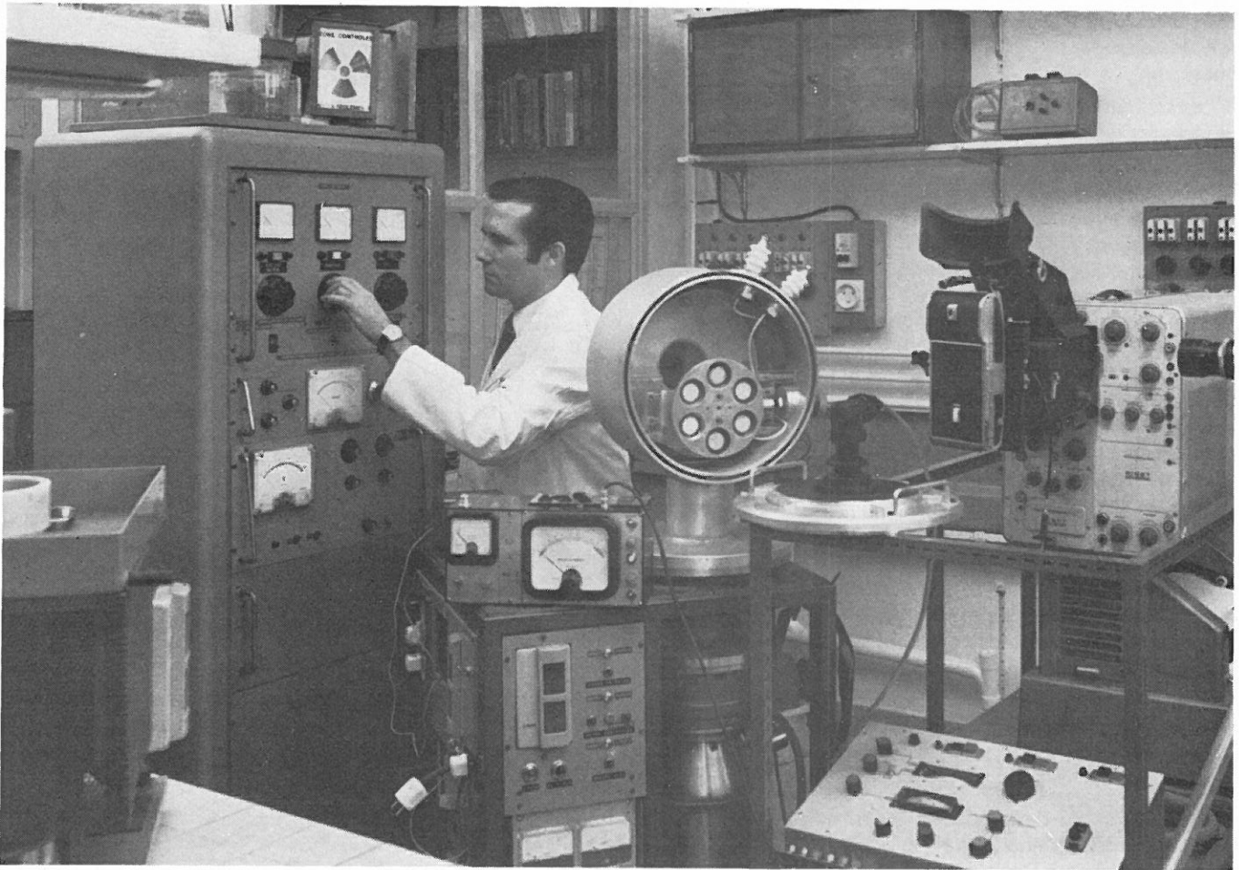
Fig. 5. - Test cathodique des luminophores sur banc d'essais réalisé par Thomson CSF (Centre de Recherches Rhône-Poulenc d'Aubervilliers).
