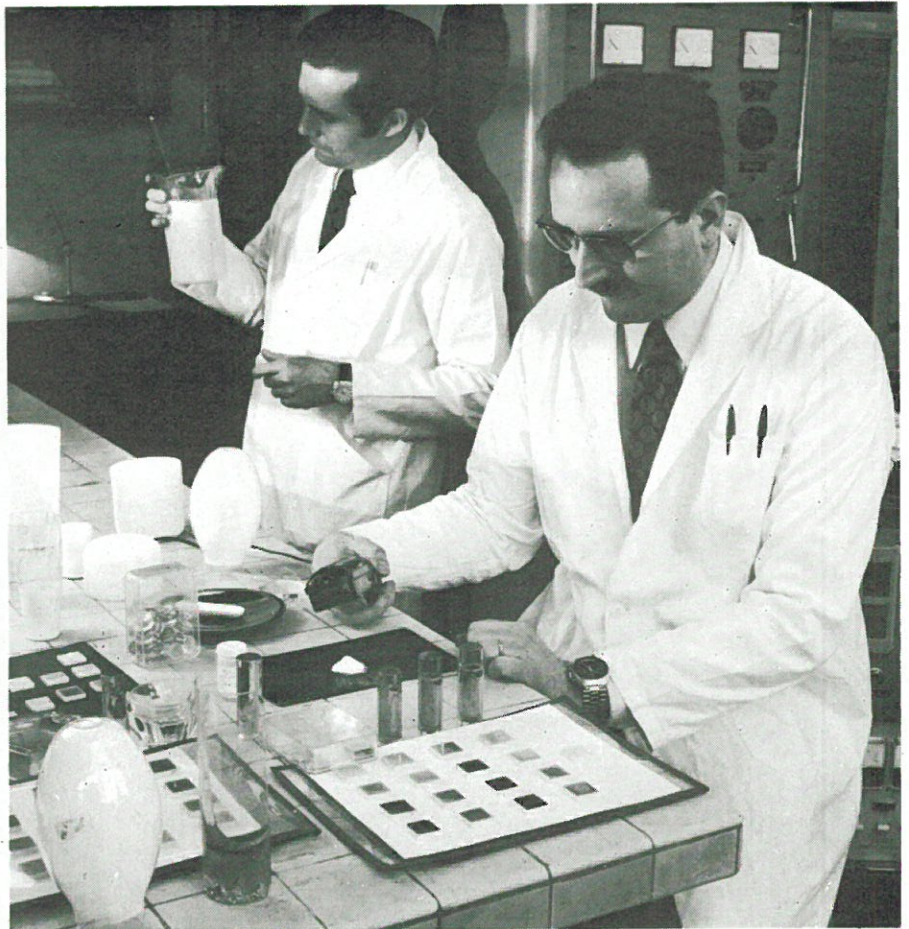
Fig. 4. - Examen d'un luminophore sous irradiation ultra-violette (Centre de Recherches Rhône-Poulenc d'Aubervilliers).
