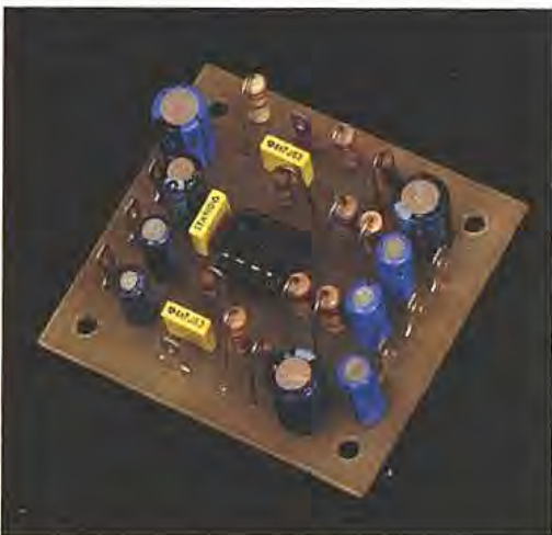
Photo 3. - Le module préamplificateur.
