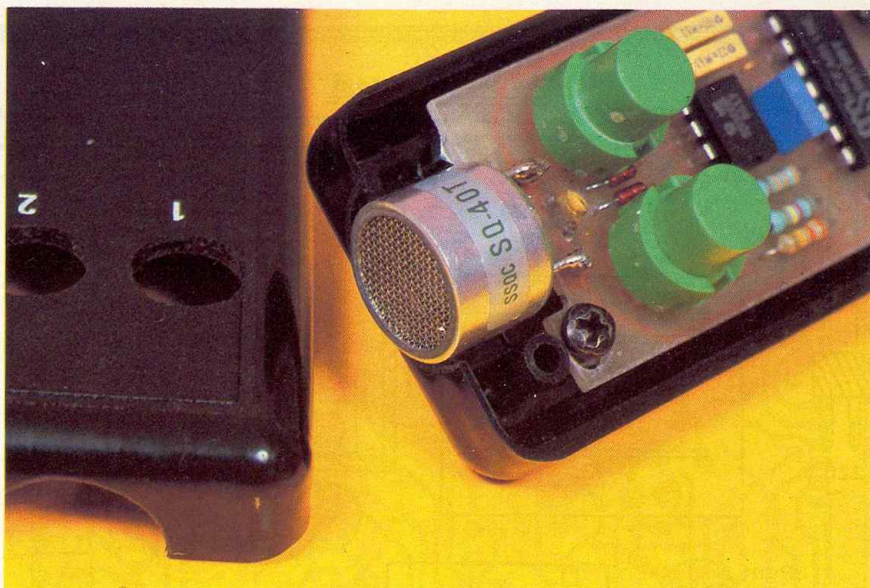
Photo 5. - Gros plan sur le transducteur.
