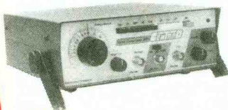
368. Générateur de fonction de 1 Hz à 200 kHz, sinus, carré, triangle, précision ± 5 %. T.T.L. Entrée wobulation extérieure 1420F
