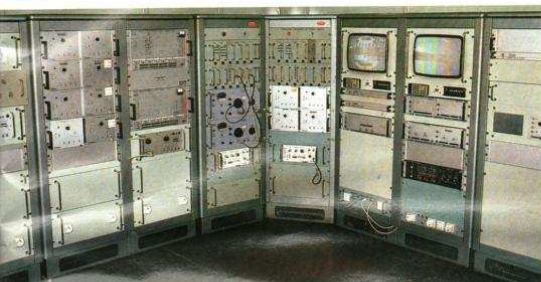
Ces baies d'instrumentation sont celles générant les mires utilisées dans l'usine pour le réglage des téléviseurs.
