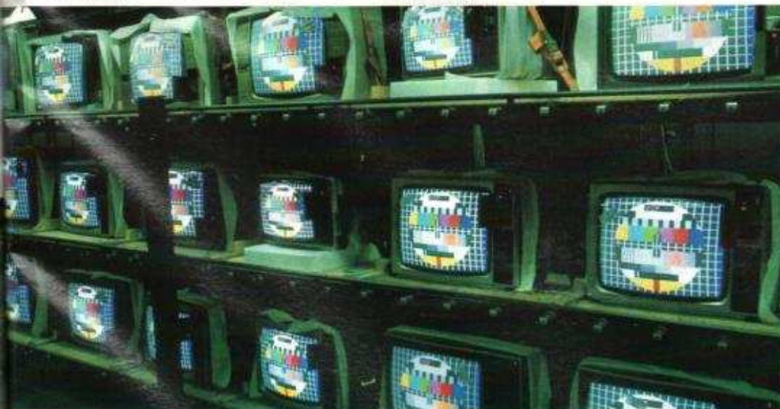
La salle de contrôle où les téléviseurs sont comparés. On vérifie ici l'équilibre photométrique des tubes et le suivi du réglage.
