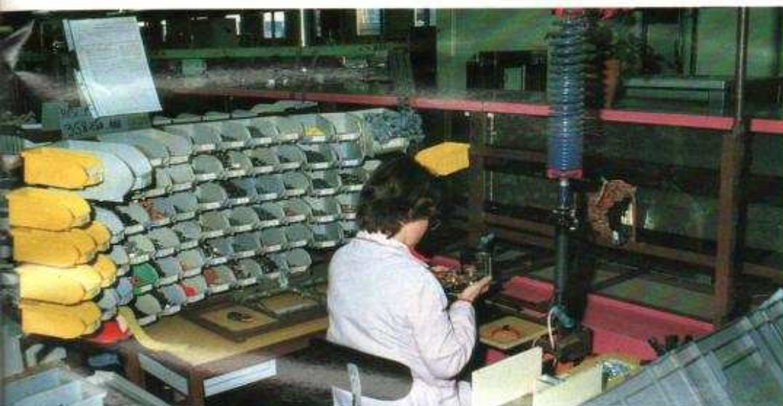
Poste individuel de montage et de vérification de circuit. Ici, on met en place les composants ne pouvant être implantés automatiquement.
