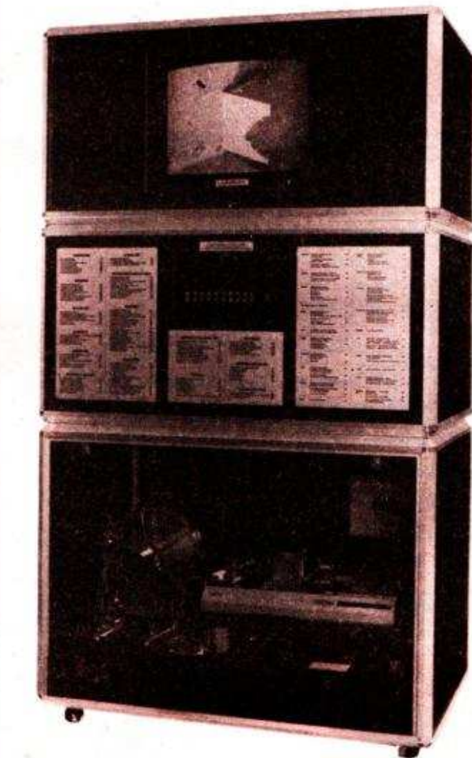
Le lecteur de disques vidéo se compose de trois parties. En haut, un moniteur ; au centre, le système de sélection de disque et, en bas, derrière la vitre : le changeur de disques.
