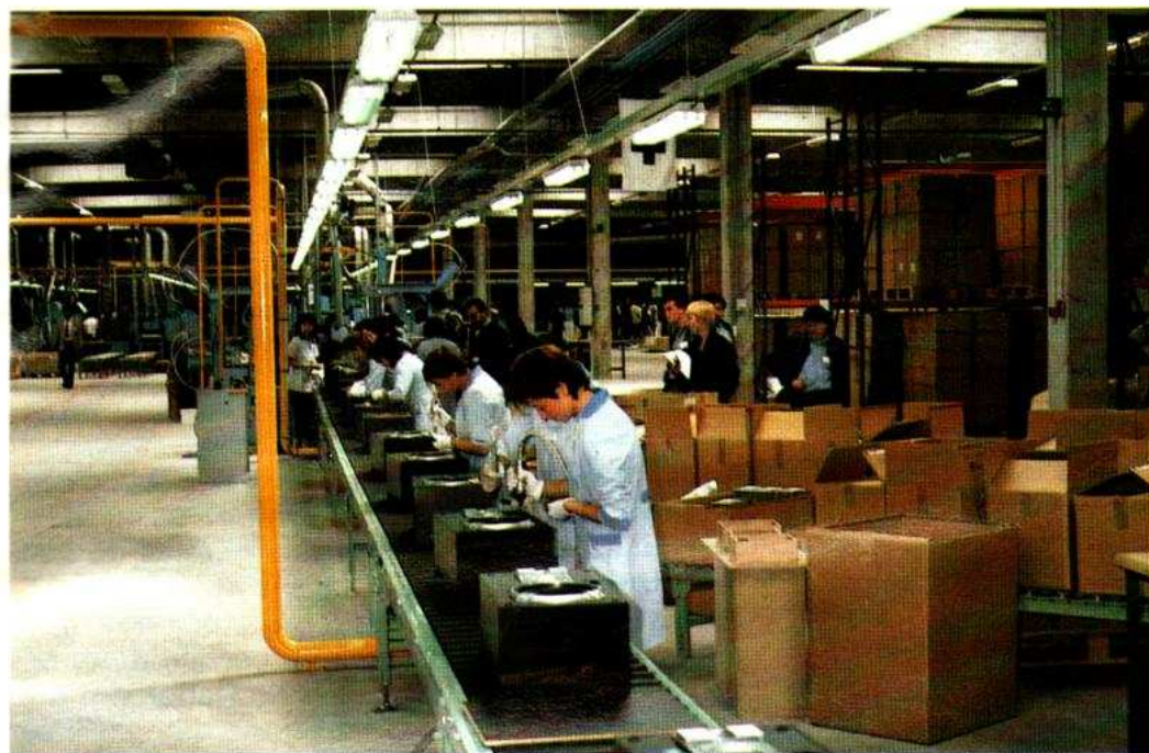
Photo C. - La mise en place de haut-parleurs dans les enceintes acoustiques.
