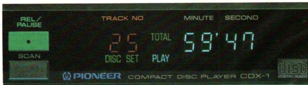
L'afficheur de bord, il annonce la durée totale du disque, à la demande, bien sûr.
