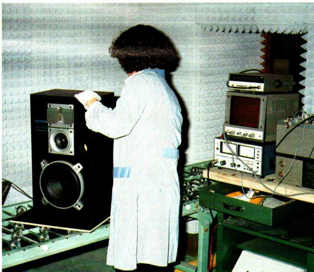
Photo D. - Avant d'être emballée, l'enceinte acoustique est mesurée en chambre sourde.
