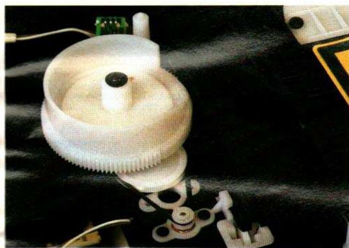
Le pignon du tiroir avec son entraînement par poulie. On voit clairement l'emplacement pour un moteur avec pignon.
