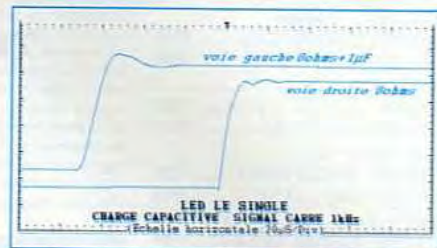
Comportement sur charge capacitive
