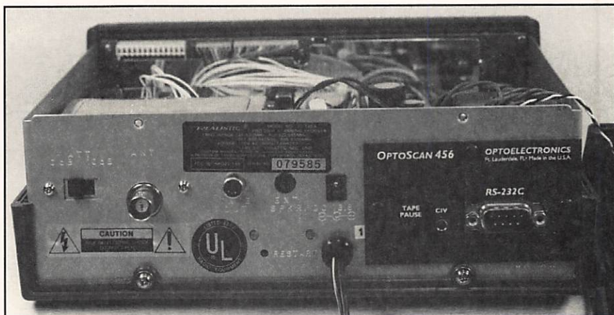
A l'arrière, on découvre la modification « OptoScan 456 ».
