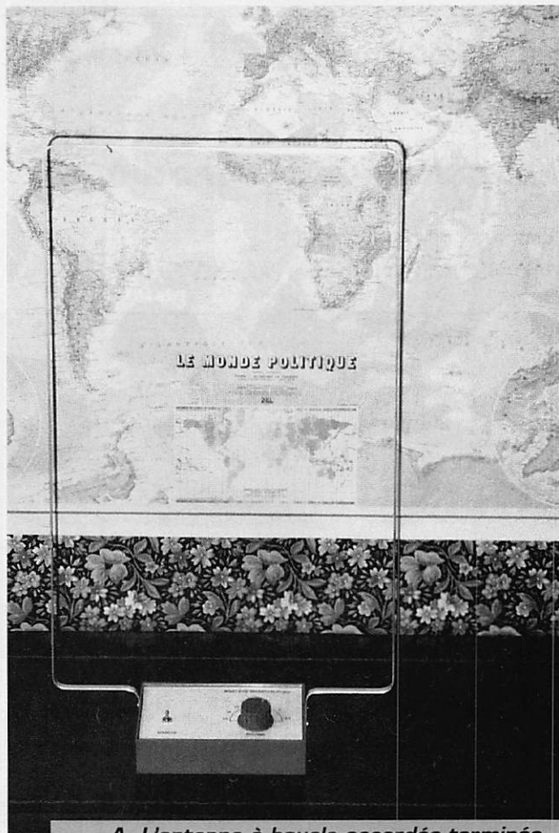
A. L'antenne à boucle accordée terminée. Du "quasi pro" !
