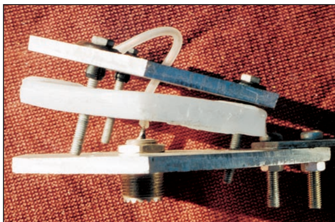
Le support démonté, sans les folioles : un fil partant de la partie centrale de la SO 232 va alimenter la plaque supérieure.
