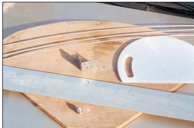
Plaque et tiges d'aluminium, planche à découper, socle S0 239, gabarit, quelques éléments nécessaires à la réalisation.
