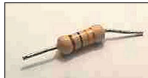
Photo 2 : Une résistance de 10 k qui ne fait que 100 ohms.
