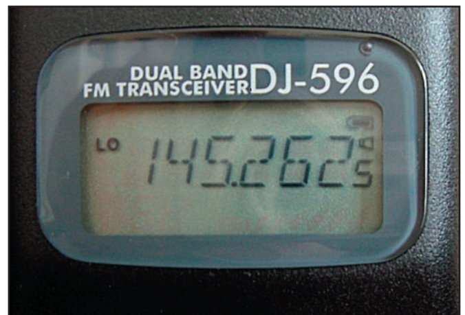
Photo 5: L'icône haut-parleur apparaît sur le LCD en mode numérique.
